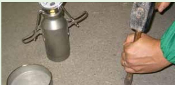
Vérifier que l'humidité résiduelle a atteint une valeur  $\leq 4\%$ . Les dalles réalisées avec DRYCEM PRONTO peuvent être imperméabilisées au bout de 24 heures dans des conditions standard.
