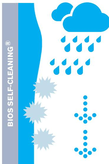
L'eau de pluie glisse sur la surface de **Bios Self-Cleaning®** en constituant une fine couche d'eau qui nettoie et élimine les salissures précédemment décomposées par l'oxygène actif Das Regenwasser breitet sich auf der Oberfläche von **Bios Self-Cleaning®** aus und erzeugt einen hauchdünnen Film, der den zuvor vom Aktivsauerstoff zersetzen Schmutz reinigt und beseitigt
