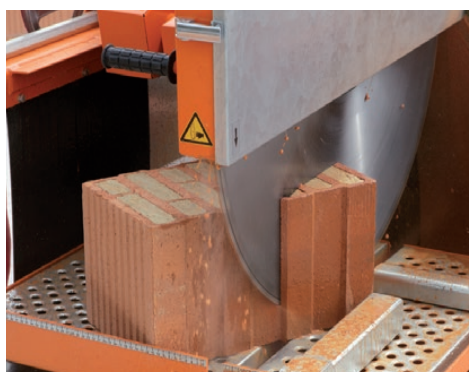
Coupe angle 45° avec une scie sur table
