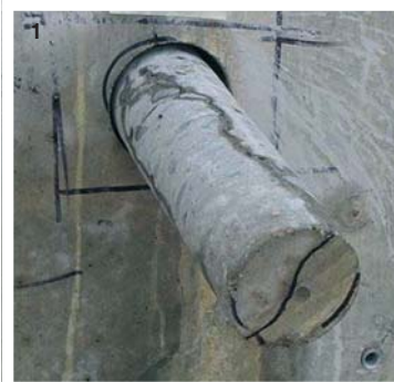
Photo 1) Echantillons d'évaluation avec carottages de la matrice en béton des structures enterrées sous nappe marine du Terminal 3 de l'aéroport de Singapour Photo 2) Présence de cristaux de différentes formes et dimensions le long d'une fissure : ils scellent complètement la craquelure (cristaux C-S-H, silicate de calcium hydraté) Photo 3) Agrandissement « BEI » (backscattered electron image) qui illustre la croissance cristalline à l'intérieur d'une microfissure Photo 4) Détail ultérieurement agrandi de l'image « BEI », qui illustre les typologies de cristaux : minces et oblongs, fins et en forme d'aiguilles.
