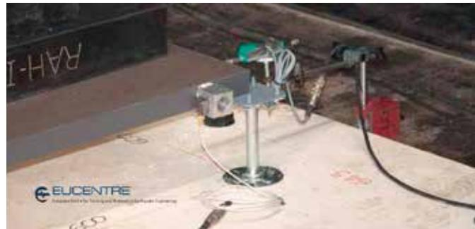
El sistema ha sido probado en EUCENTRE, European Centre for Training and Research in Earthquake Engineering de Pavia. La prueba consistió en la aplicación de excitación sísmica en la base de la estructura de metal. Al finalizar las pruebas, la estructura y la pavimentación, sometidas a pruebas acelerométricas igual a 4,5 veces el terremoto del 6 de abril de 2009 que tuvo lugar en L'Aquila (momento magnitud Mw 6,3 en la escala de Richter), no han mostrado un nivel de daño significativo.
