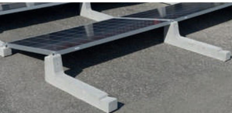
Le lest Connect répond à n'importe quel type de module avec cadre prévu pour une pose horizontale. La distance entre les rangées est déterminée par la mesure du module, par conséquent, lorsque l'on met la première rangée à l'équerre, le reste vient tout seul, plus facile et plus rapide que jamais.
